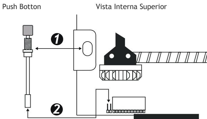
3. Após completar a instalação do Push Bottom coloque novamente a carcaça externa do PLUS, o Push Bottom deve sobre sair pelo furo exterior para utilização do equipamento conforme figura.
